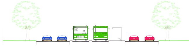
Figura 2: Diseño Tipo 1 ( T_1 ), Una Pista sin Adelantamiento
