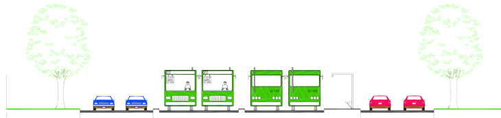
Figura 4: Diseño Tipo 3 ( T_3 ), Dos Pistas Continuas
